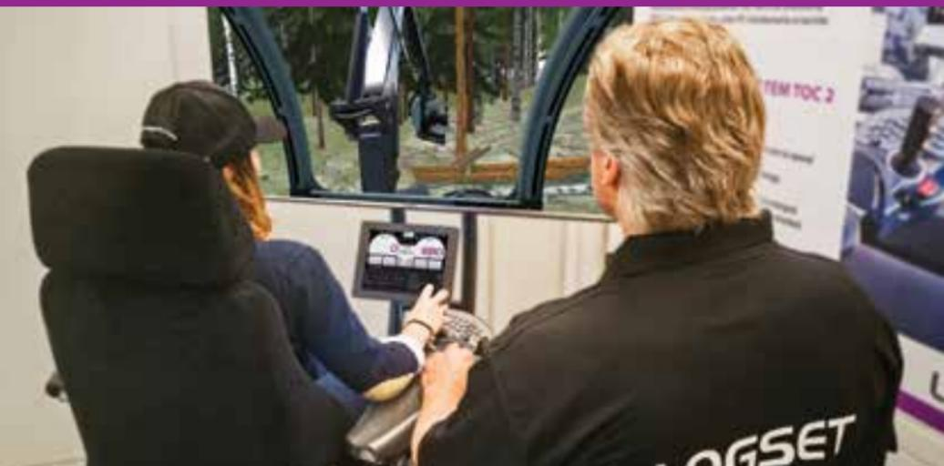
Der Logset Simulator hat ein genaues Verhalten und hervorragende Grafiken. Die Stärke liegt in der genauen Simulation der Dynamik. Hydraulische Drücke und Strömungen so wie mechanische Kräfte werden realistisch simuliert. Das Steuerungs- und Messsystem verhält sich so, als ob es in eine reale Maschine eingebaut wäre.
